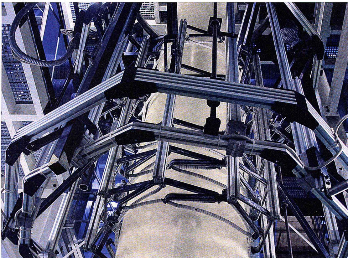
Bild 1: Der Biokunststoff aus der Schweiz kann mit dem üblichen Extrusionsverfahren zum Green-Bag verarbeitet werden.
